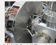
入射部用ビーム位置モニタ(左)と実ビーム試験での信号出力(右)@PF-AR南実験棟
