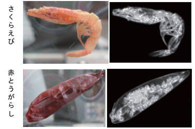
可視光のイメージ THz波イメージ 周波数: 1.0 THz (波長0.3 mm) 空間分解能: 0.4 mm
